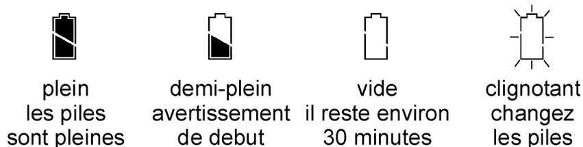
**3 – Alarme laser basculé & avertissement piles laser:** Quelques lasers rotatifs ralentissent leur vitesse de rotation dès qu'ils sont perturbés (basculés) ou dès que leurs piles sont presque vides. METOR est capable de reconnaître des perturbations semblables et indique par un icône de laser avec un niveau à bulle croisé ou une pile la perturbation correspondante, si cette fonction d'avertissement est activée.
