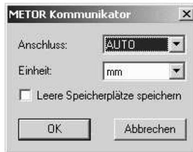
**Anschluss:** legt die Schnittstelle fest, auf der Daten empfangen werden. Es werden nur die an Ihrem Computer verfügbaren Schnittstellen aufgelistet.
