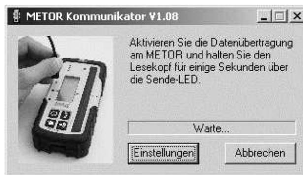
Beim ersten Start sucht METOR Kommunikator auf allen verfügbaren Schnittstellen nach einer aktiven Datenverbindung zu einem METOR Laserhandempfänger.
