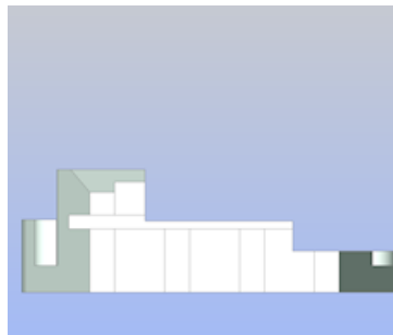
Der Teil des Volumenkörpers, der gegenüber des eingegebenen Richtungs- Punktes liegt, wird weggeschnitten.
